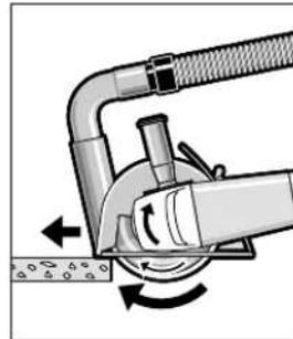
Ligar a ferramenta eléctrica e colocá-la com a parte dianteira do carril de guia sobre a peça a ser trabalhada. Empurrar a ferramenta eléctrica com avanço moderado, adequado ao material a ser trabalho.
