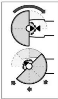
Colocar a capa de protecção 12 sobre a gola do veio, como indicado na figura. As marcas triangulares na tampa de protecção devem coincidir com as respectivas marcas da cabeça da engrenagem.
