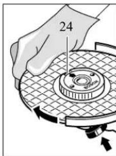
Premir a tecla de bloqueio do veio 2 para imobilizar o veio de rectificação. Girar o disco abrasivo fortemente no sentido dos ponteiros do relógio para apertar a porca de aperto rápido.
