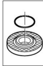
No flange de admissão 8 encontra-se uma peça de plástico (o-ring) em volta do colar de centragem. Se o o-ring estiver faltando ou estiver danificado, será imprescindível substituí-lo (número de produto 1 600 210 039), antes de montar o flange de admissão 8.
